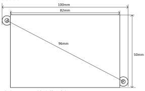
备注: 高度32mm, 对角安装孔直径4mm
