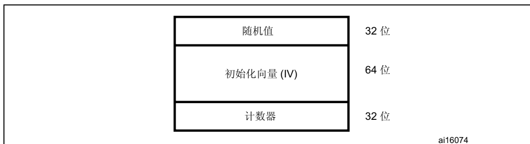
图 213. 计数器模式下的初始计数器块结构
