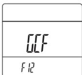
在F12-GCF菜单下，按 **(M)** 键进入气体修正因子设置界面。默认气体修正因子为1000，可通过 **(M)** 键与 **(▲)**/**(▼)** 键组合方式设置新的气体修正因子。
