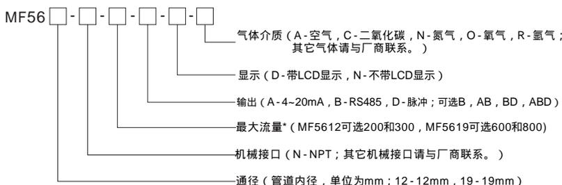
\* 最大流量的单位为L/min（标况，LCD显示为SLPM），比如200代表最大流量为200L/min；对二氧化碳，MF5612最大流量可选200，不可选300；MF5619最大流量可选600，不可选800。
