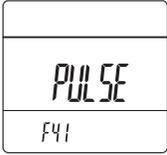
在F41-PULSE菜单下，按 **(M)** 键进入总量单位设置界面。默认为每个脉冲对应1SL(显示1)，可通过 **(▲)**/**(▼)** 键切换为0.001SL(显示10-3)，0.01SL(显示10-2)，0.1SL(显示10-1)或10SL(显示10)。按 **(M)** 键后选择是否保存。
