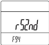
在F94-rS2nd菜单下，按 **(M)** 键输入密码，密码正确后进入恢复二次修正因子。
