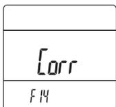
在F14-Corr菜单下，按 **(M)** 键输入密码，密码正确后进入二次修正因子设置界面。详细的设置方法请与厂商联系。
