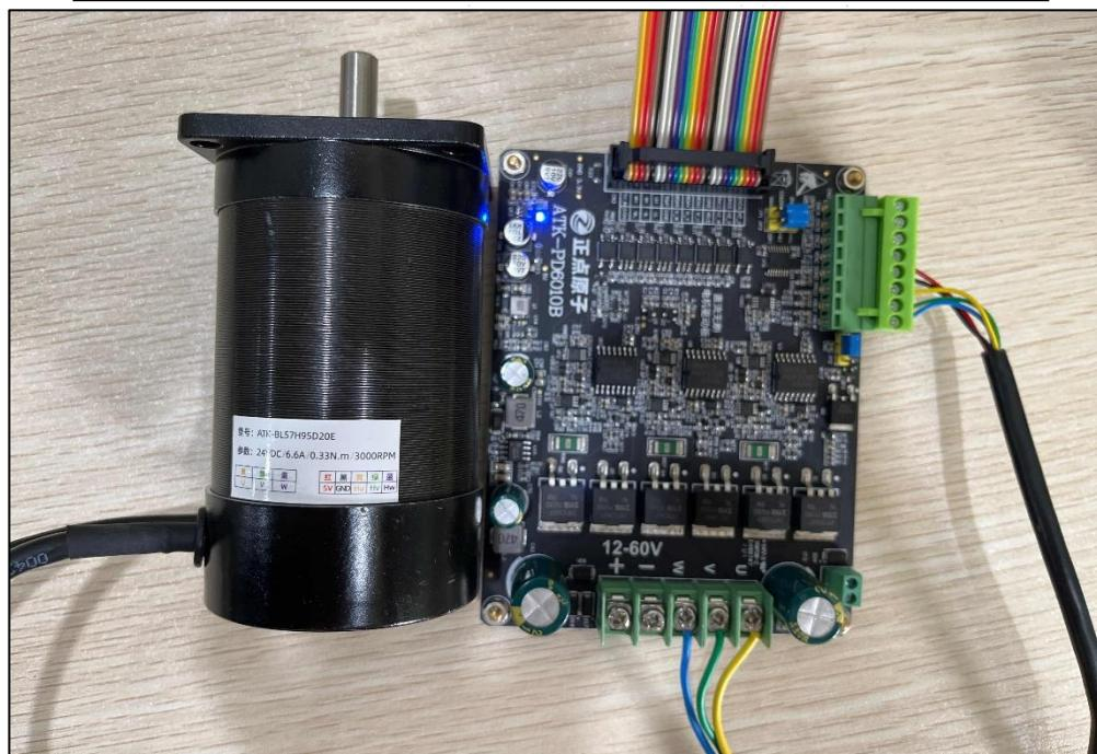
第三步：给驱动板接上直流电源，大家需要根据具体的电机工作电压选择，如果是配套的直流无刷电机，则选择 24V DC 电源即可，值得注意的是，**驱动板的输入电源正负极不要接反!!!**
