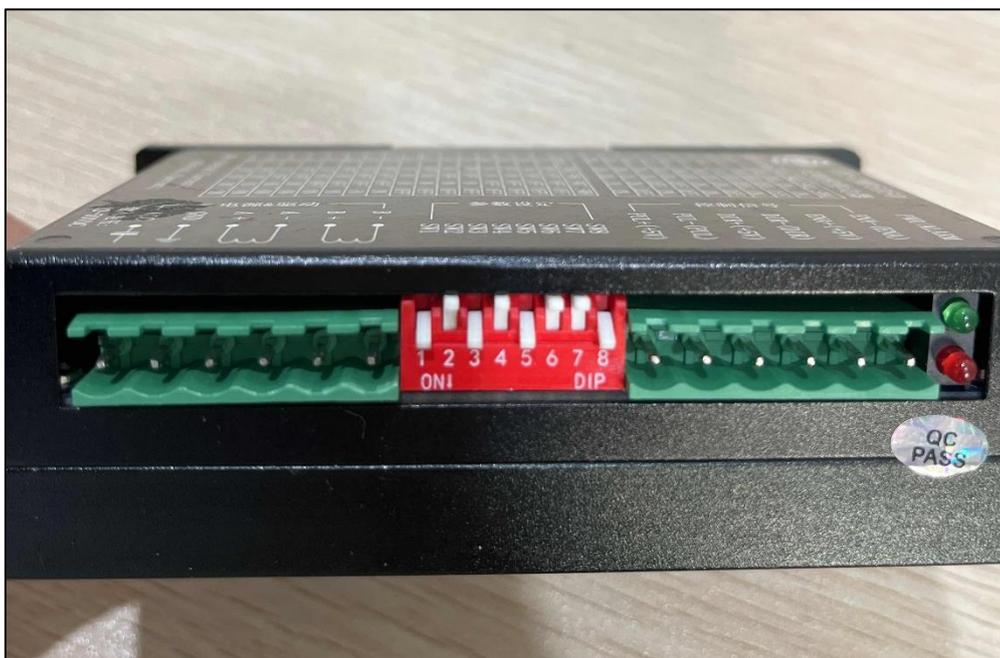
第二步：根据步进电机驱动器接口丝印以及电机接口标签进行相应的接线，然后把信号端子接到开发板的步进电机驱动接口 4，如下图所示：
