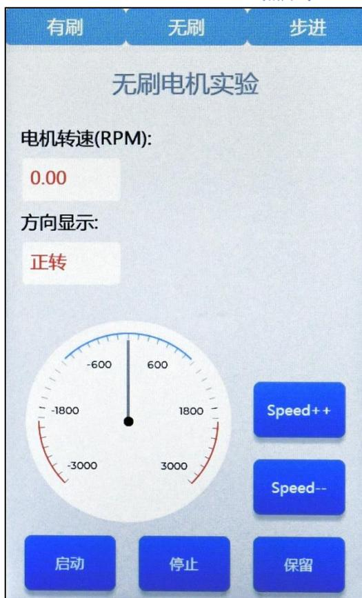
大家根据屏幕的显示进行操作即可，如果您的套餐里面没有屏幕，则可以自行烧录：**实验 9-2 BLDC 基础驱动 2 路** 进行测试，具体路径如下：A 盘—程序源码—电机专题代码—实验 9-2，烧录完该代码之后，可通过按键控制电机。
